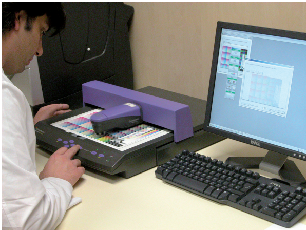
Fig. 1. Espectrofotómetro Spectroscan de X-RITE Fig.2. Medición espectrofotométrica de un papel sobre dos superficies diferentes
